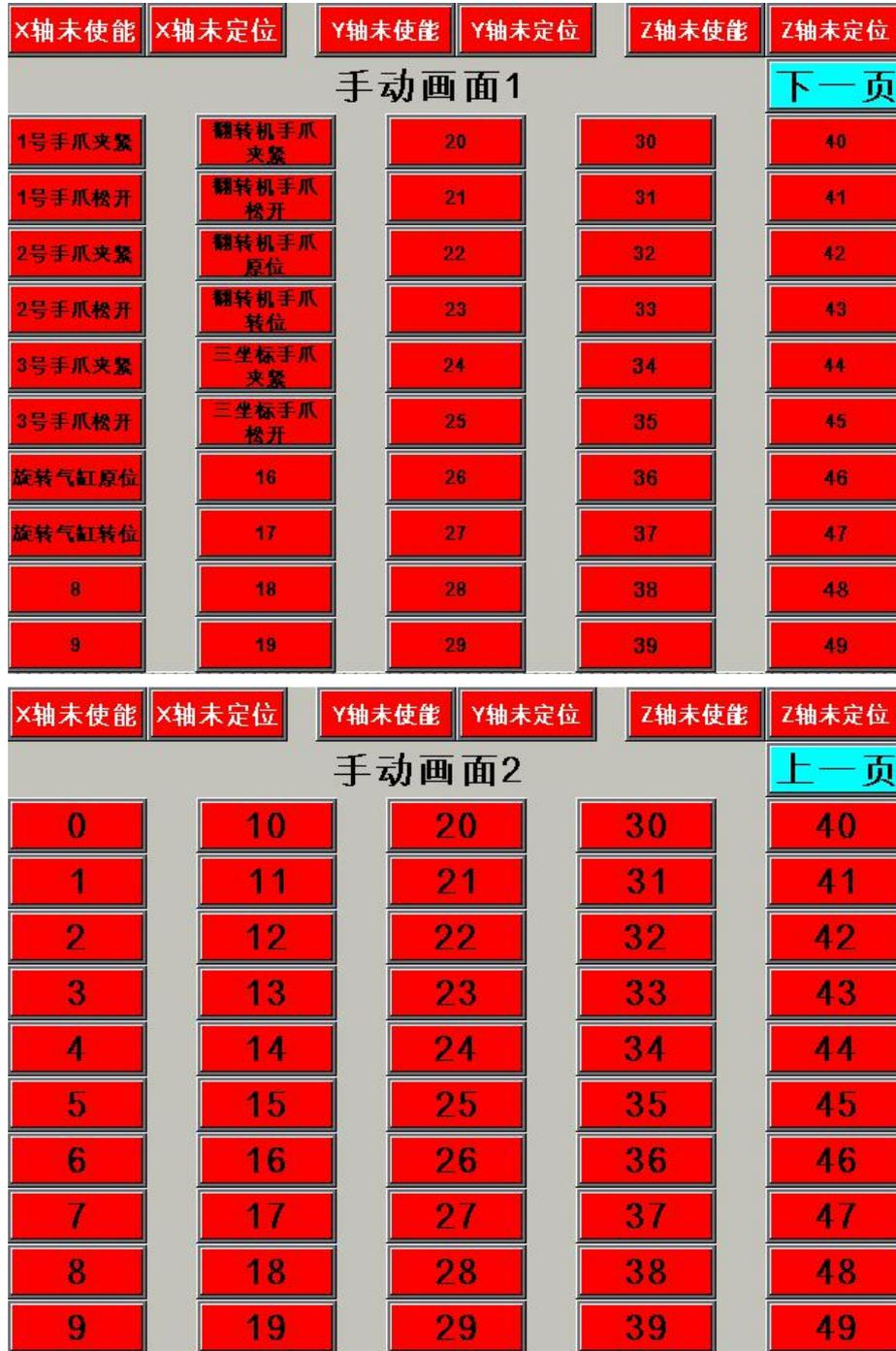
此界面分为手动按钮界面，包括手爪、空压泵及润滑泵等设备的手动操作按钮，手动控制部分，具体定义按照项目实际需求进行添加。
